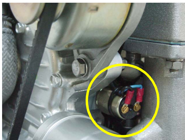
Fig. E.2.7-6: Interrupteur à pression d'huile sur le moteur diesel
