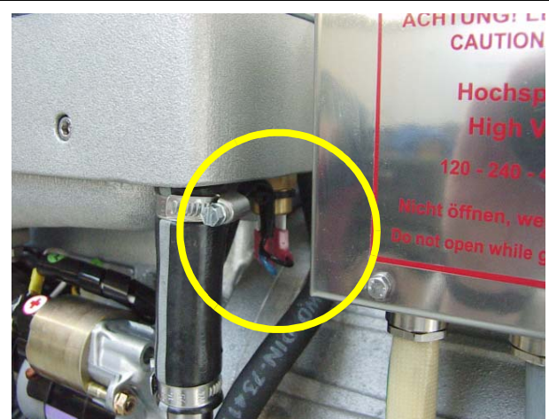
Fig. E.2.7-2: Thermo-rupteur sur le collecteur d'échappement refroidi à l'eau
