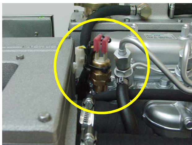
Fig. E.2.7-1: Thermo-rupteurs sur la culasse
