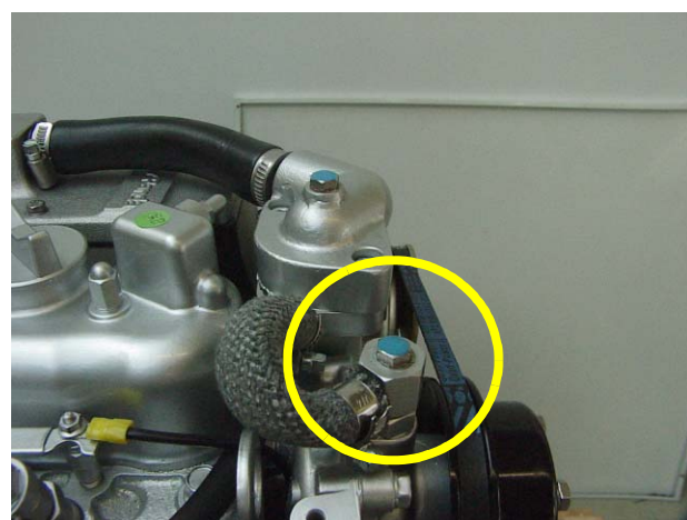
Fig. E.2.3-9: Vis de purge d'air Pompe d'eau de refroidissement
